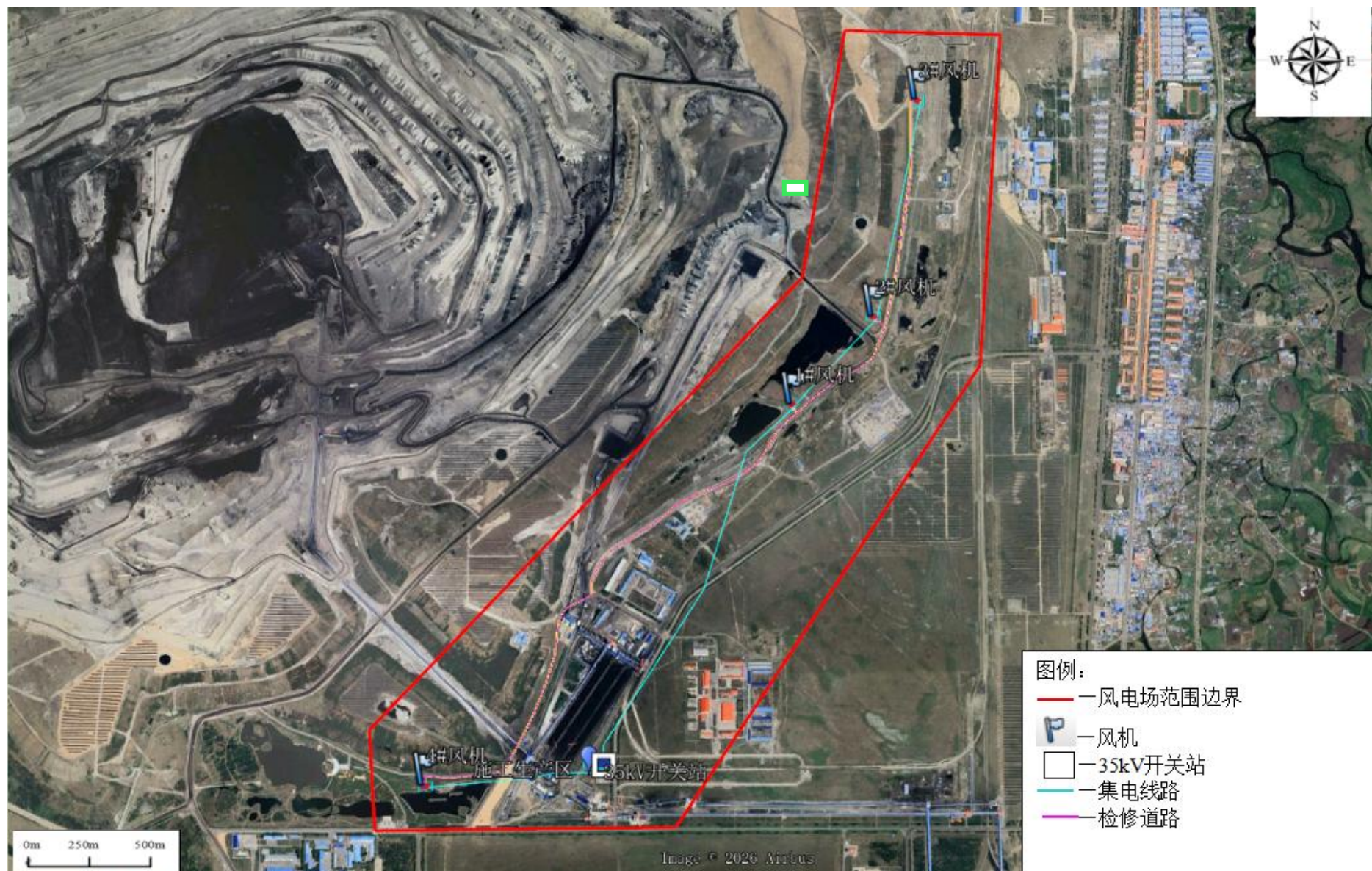
附图2 风电场平面布置图
