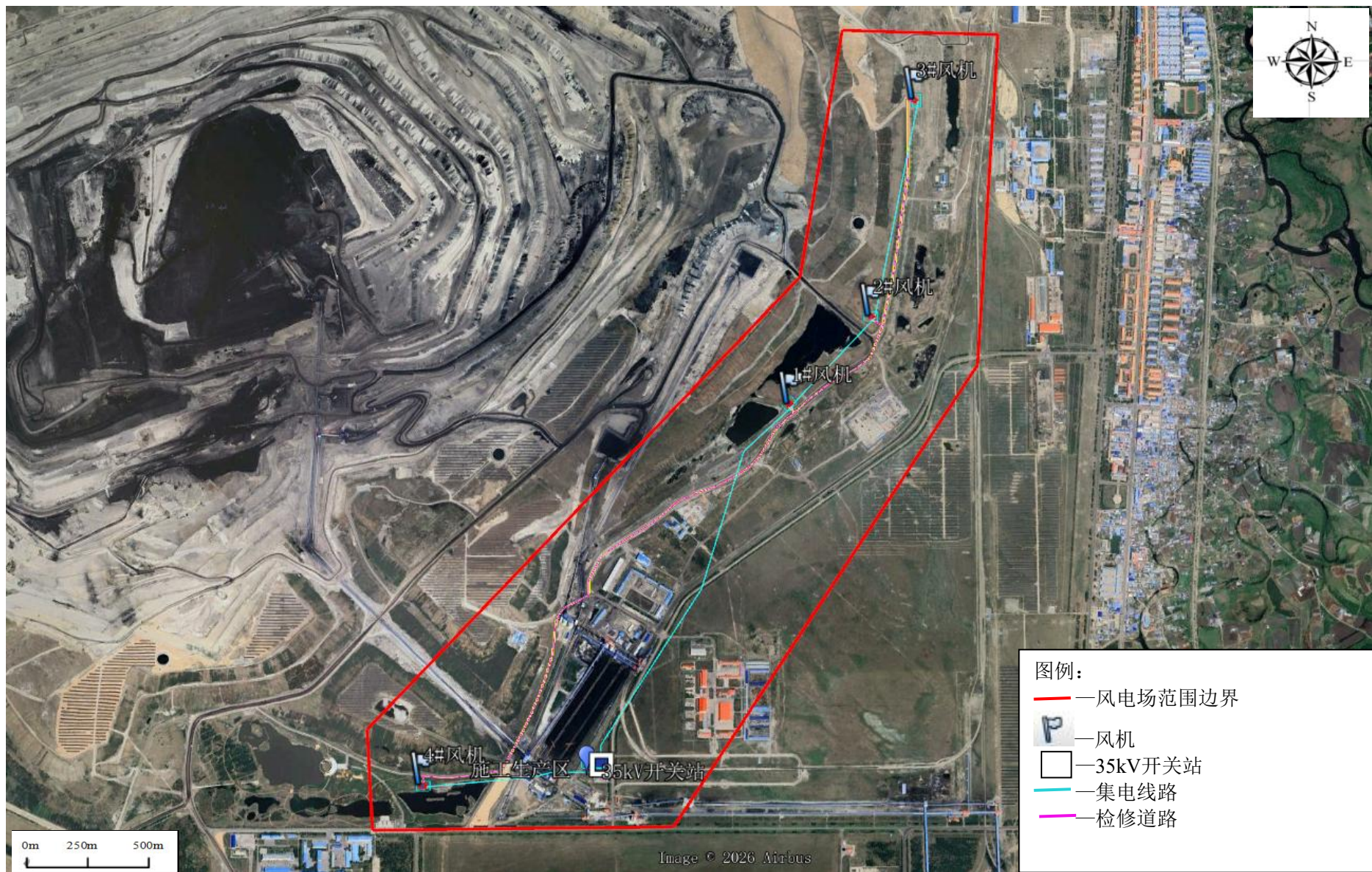
附图3 集电线路路径图
